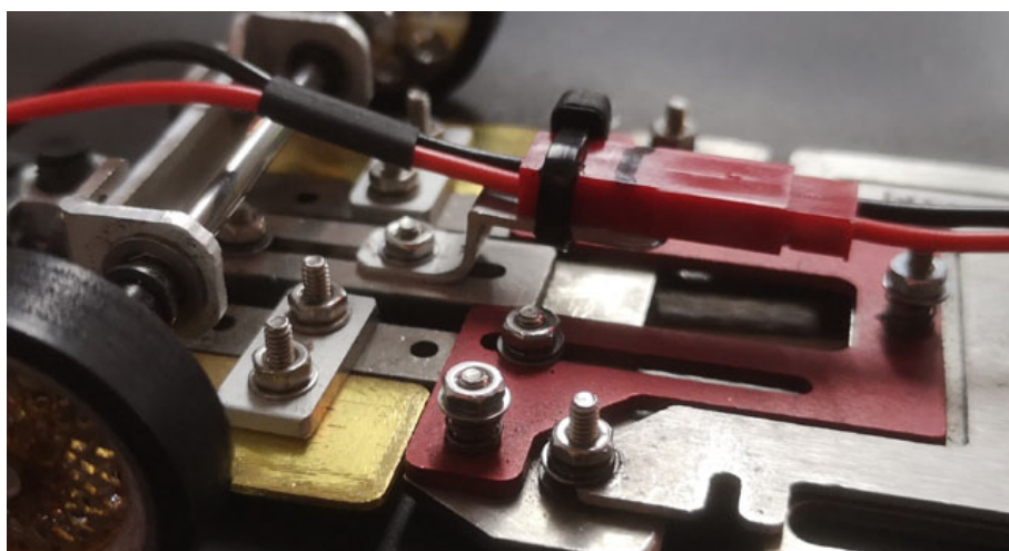
Bild 05: Beispiel für einen Halter aus Aluminium zur Führung des Anschlusskabels zum Leitkiel.
